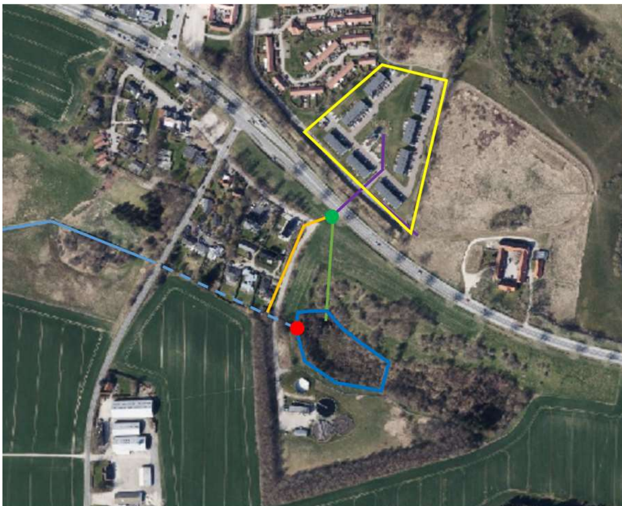
Figur 1: Udsnit af projektområdet. Der etableres en ny vandledning (grøn) og nye rense/fordeler brønde (grøn prik), for at aflaste vandtilførsel til eksisterende vandløb langs Højrisvej (orange). Vandet ledes til det eksisterende og nye vandløb fra opstrøms vandløb (lilla), herunder fra et nyt boligområde ved Julemosevænge (gul markering). Ny ledning afleder til mosen (blå markering) for med forsinkelse at ledes videre gennem afløbsbrønd (rød prik) til Kedelsø Å (blå linje). Afløbsbrønd etableres med nedroslet udløb og overløbsudløb med kote der sikrer den østlige del af mosen mod påvirkning.
